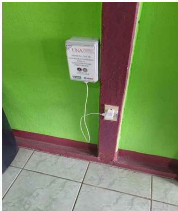
图 1 一款用于地震预警的智能手机被装在固定在墙上的盒子里
